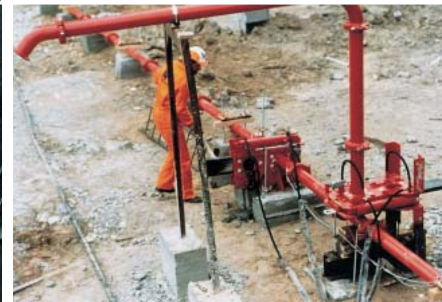
Station de nettoyage pour des tuyauteries stationnaires au moyen de systèmes de tiroirs d'arrêt
