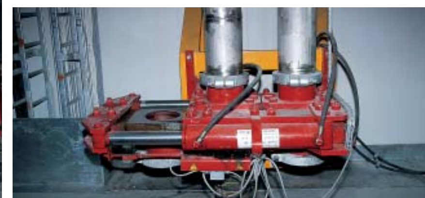
DVH 4/2: multi-raccord résistant à haute pression, pour l'alimentation au choix de 2 tuyauteries
