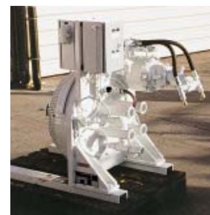
Tiroir rotatif pour l'alimentation de plusieurs tuyauteries
