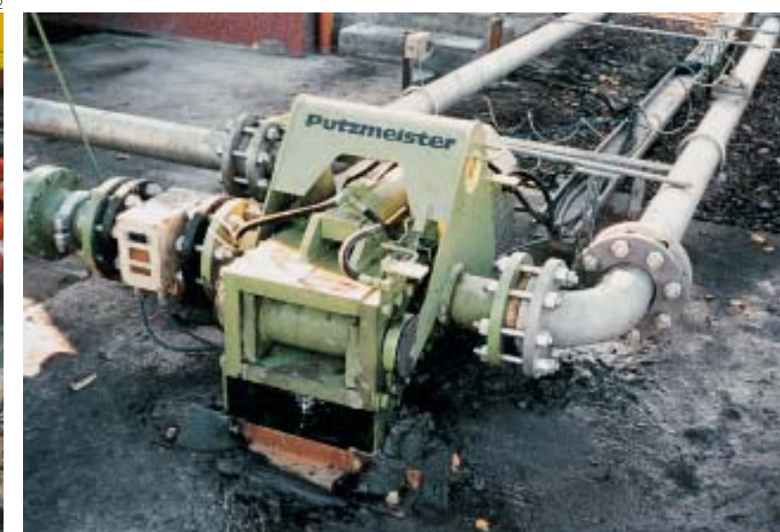
Vannes de nettoyage-PM pour l'entrée et la sortie d'obus dans des tuyauteries
