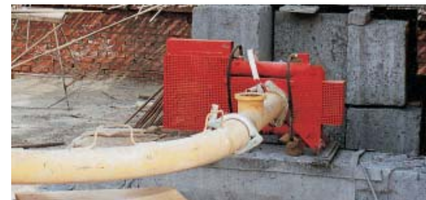
GVH 2/2: tiroir d'arrêt résistant à haute pression, pour fermer des tuyauteries
