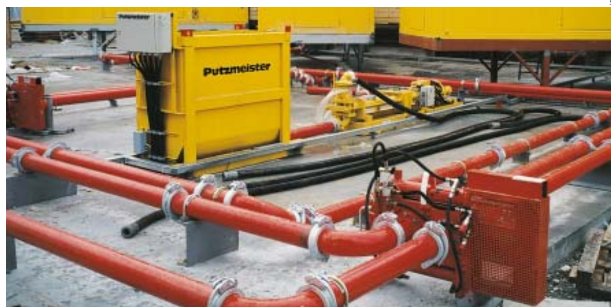
Des tiroirs et aiguillages permettent une installation facile de systèmes de conduites complexes avec des tuyauteries PM, ici le système de distribution SK à Oeresund, Danemark
