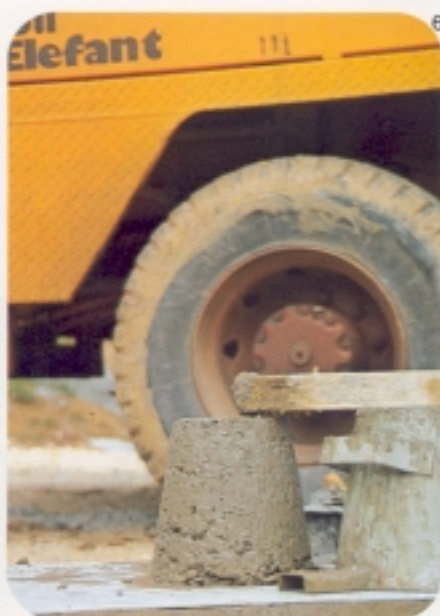
Kiesreicher und sandarmer Hochwertbeton – WZ kleiner 0,5. Setzmaß 1 cm, Ausbreitmaß 34–36 cm.
